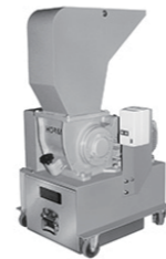
機 械 名 / P-1314 モーター / 6P 0.75kW 機械寸法 / 535mm (W) 625mm (L) 970mm (H) 機械重量 / 130kg
