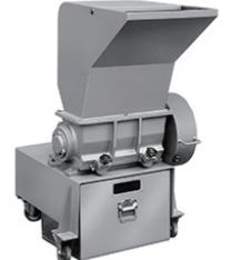
機 械 名 / P-1342 モーター / 6P 1.5kW 機械寸法 / 720mm (W) 975mm (L) 1,150mm (H) 機械重量 / 250 kg
